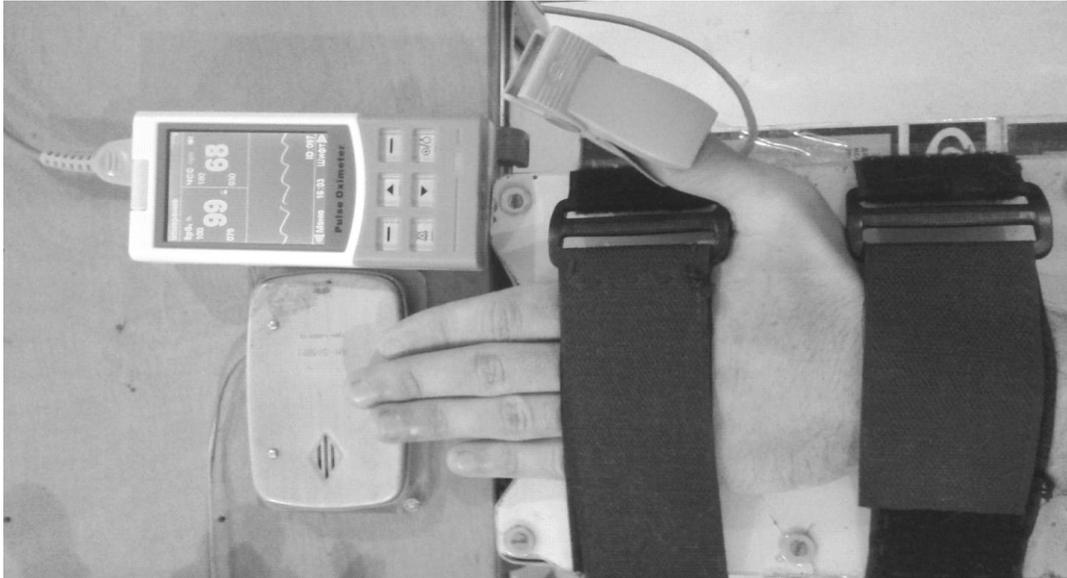
Рис.1. Схема экспериментальной установки для исследований непроизвольной и произвольной ритмической активности пальцев руки, с синхронной портативной регистрацией функций сердечно-сосудистой системы
